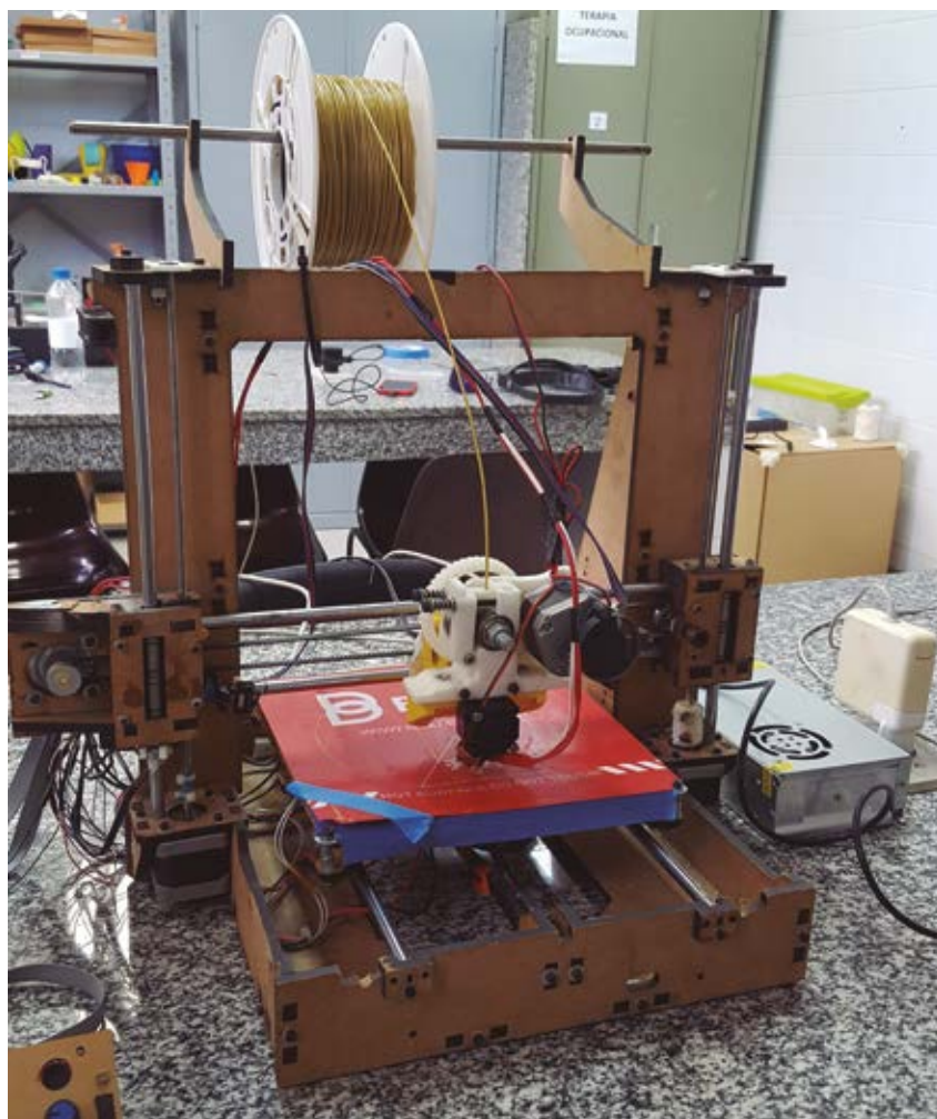
A impressora 3D utilizada pelos pesquisadores da UFES para imprimir órteses e próteses.
